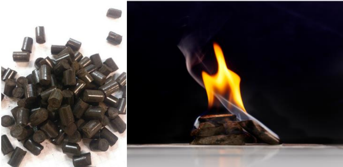
Figuur 45: Biochar en hydrochar geproduceerd met het HTC-proces van C-Green (Bron: C-Green)
