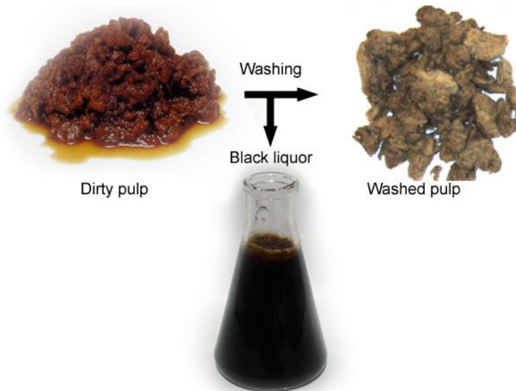
Figuur 37: Het wassen van vuile pulp levert black liquor en gewassen pulp op (KnowPulp, 2019)
