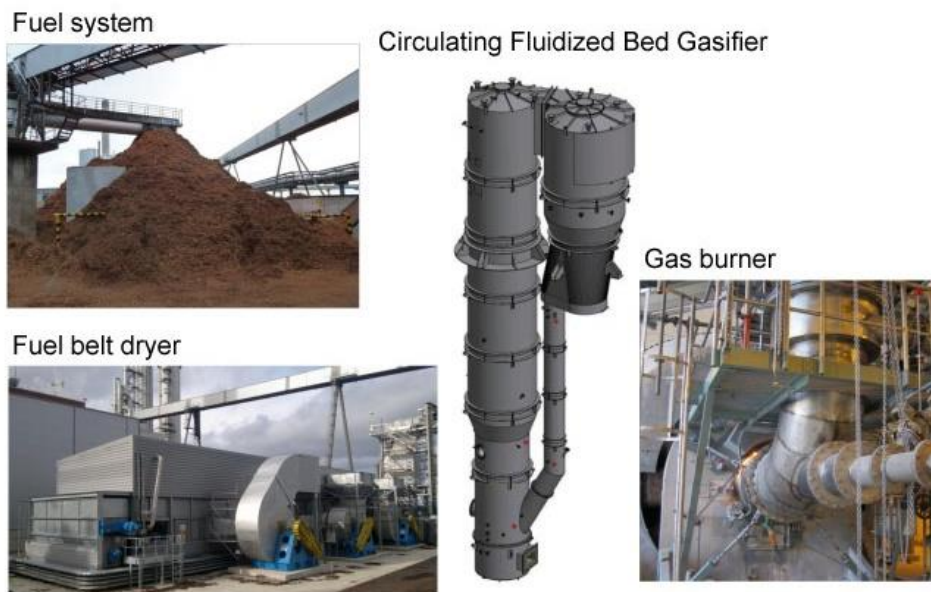
Figuur 50: Onderdelen van een vergassingsinstallatie (Know pulp, 2019)
