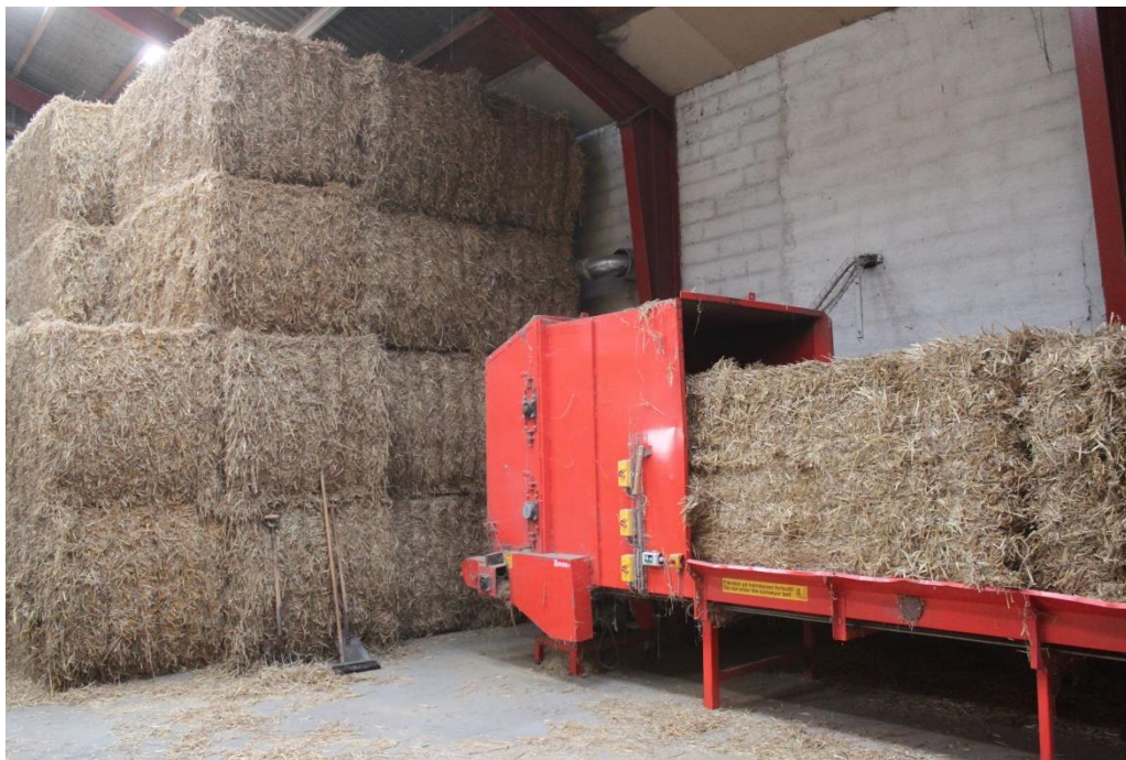
Figuur 11: Strobaalaanvoersysteem voor een stadsverwarmingsnet in Denemarken (Bron: D. Rutz)
