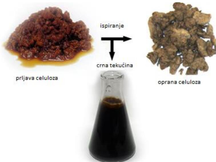
Slika 28: Ispiranjem prljave pulpe nastaje crna tekućina i oprana celuloza (KnowPulp, 2019)
