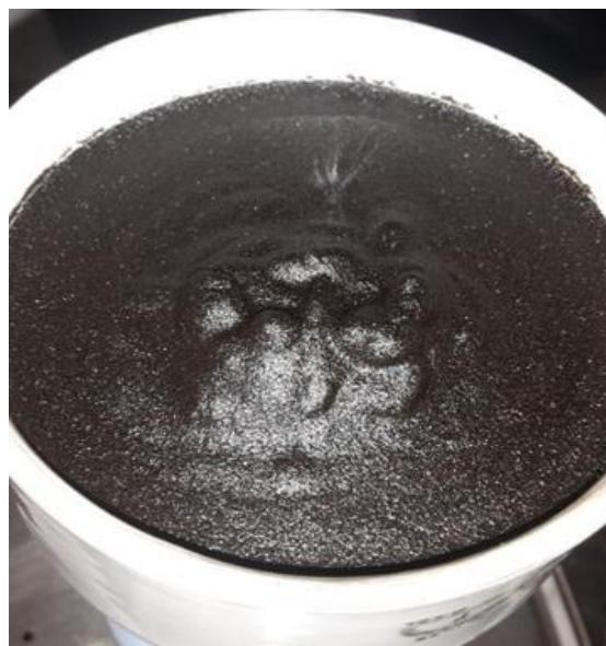
Slika 39: Sirovina proizvedena hidrotermičkim ukapljivanjem iz crne tekućine (Izvor: VTT)
