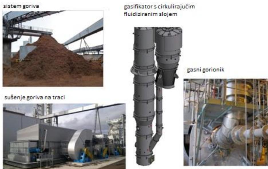
Slika 41: Komponente gasifikacijskog postrojenja (Know pulp, 2019)
