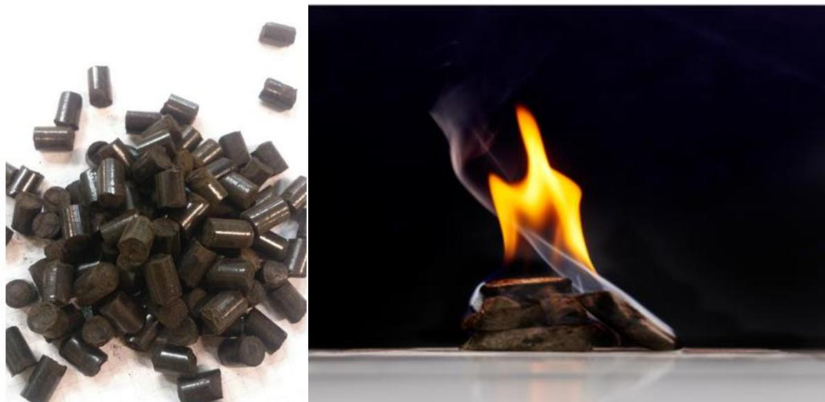
**Slika 36:** Biougljeni peleti i voden ugalj proizvedeni u procesu hidrotermičke karbonizacije C-Green (Izvor: C-Green)
