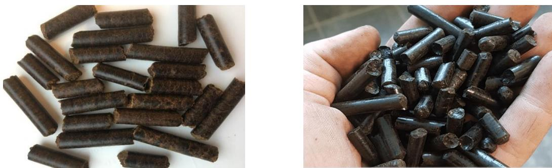
**Slika 9:** Termički tretirani peteti biomase. Lijevo: parom ekplodirani drveni peleti Arbacore (Izvor: Arbaflame). Desno: toreficirani drveni peleti (Izvor: Yilkins)
