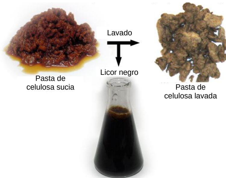
Figura 37: El lavado de pasta de celulosa sucia produce licor negro y pasta de celulosa lavada (KnowPulp, 2019)
