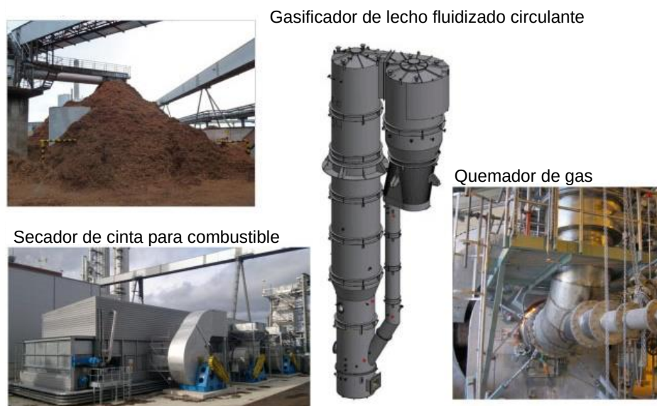
Figura 50: Componentes de una planta de gasificación (Know pulp, 2019)
