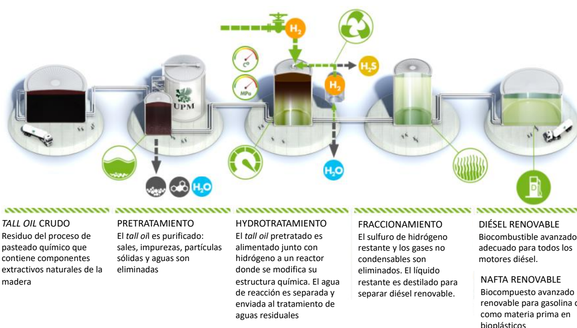
Figura 52: Diagrama de flujo de la producción de diésel renovable de UPM (Fuente: UPM 48 )
