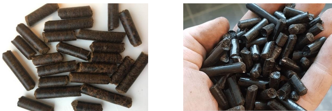
Figura 9: Pellets de biomasa tratados térmicamente. Izquierda: pellets de madera de Arbacore sometidos a explosión de vapor (Fuente: Arbaflame). Derecha: pellets de madera torrefactos (Fuente: Yilkins)
