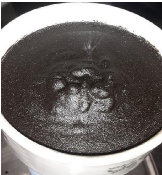
Εικόνα 48: Ακατέργαστο HTL που παράγεται από μαύρο υγρό (Πηγή: VTT)
