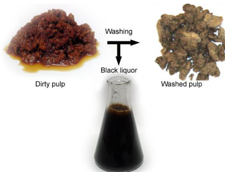
Εικόνα 37: Η πλύση του πολτού με προσμίξεις παράγει μαύρο υγρό και καθαρό πολτό (KnowPulp, 2019)
