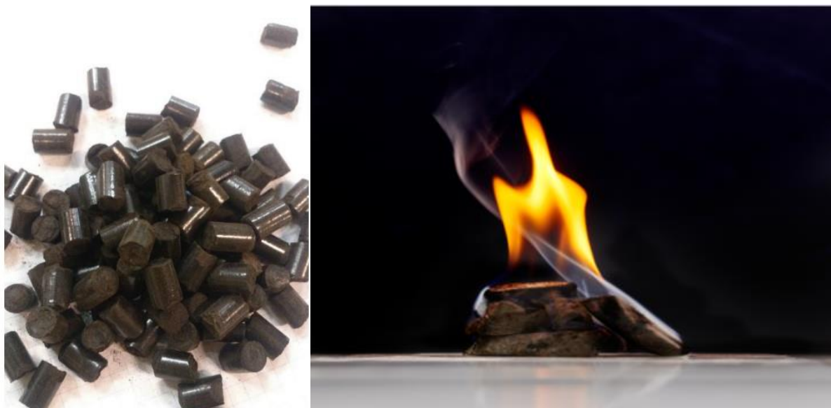
Εικόνα 45: Πέλλετες βιο-άνθρακα και υδροεξανθρακώματος με τη διαδικασία HTC της C-Green (Πηγή: C-Green)
