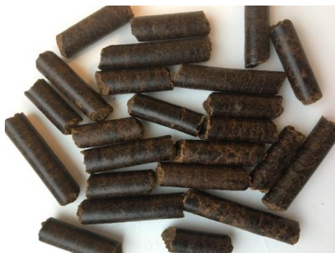
Εικόνα 9: Θερμικά επεξεργασμένα πέλλετ βιομάζας. Αριστερά: ξύλο Arbacore μετά από έκθεση σε ζεστό ατμό (Πηγή: Arbaflame). Δεξιά: πέλλετ ξύλου μετά από φρύξη (Πηγή: Yilkins)
