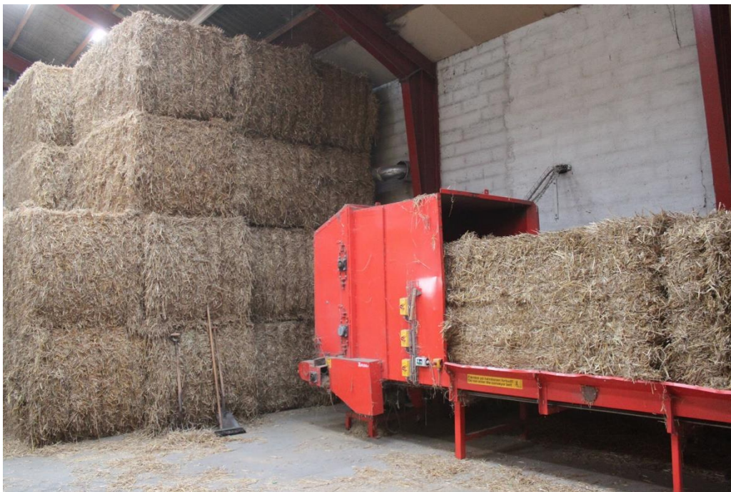
Εικόνα 11: Σύστημα τροφοδοσίας αχύρου για δίκτυο τηλεθέρμανσης στην Δανία (Πηγή: D.Rutz)
