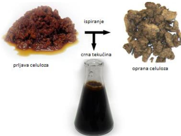
Slika 37: Ispiranjem prijave pulpe nastaje crna tekućina i oprana celuloza (KnowPulp, 2019)
