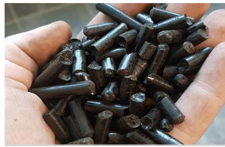
**Slika 9: Termički tretirani peteti biomase. Lijevo: parom ekplodirani drveni peleti Arbacore (Izvor: Arbaflame). Desno: toreficirani drvni peleti (Izvor: Yilkins)**
