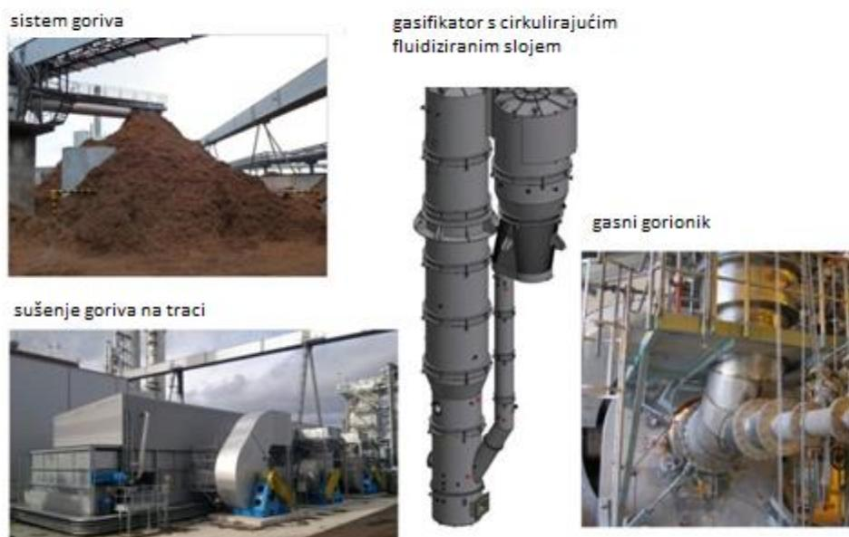
Slika 50: Komponente gasifikacijskog postrojenja (Know pulp, 2019)
