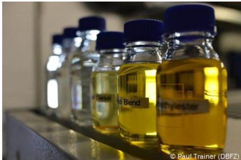
Slika 17: Biodizel, mješavina biodizela i fosilni dizel (Izvor: DBFZ)
