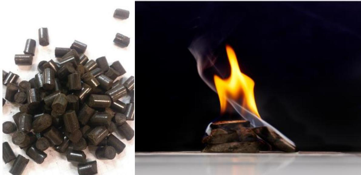
**Slika 45:** Biougljeni peleti i voden ugalj proizvedeni u procesu hidrotermičke karbonizacije C-Green (Izvor: C-Green)
