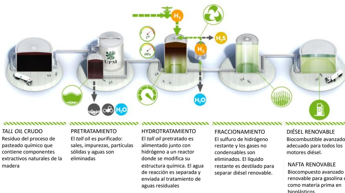
Figura 53: Diagrama de flujo de la producción de diésel renovable de UPM (Fuente: UPM<sup>56</sup>)
