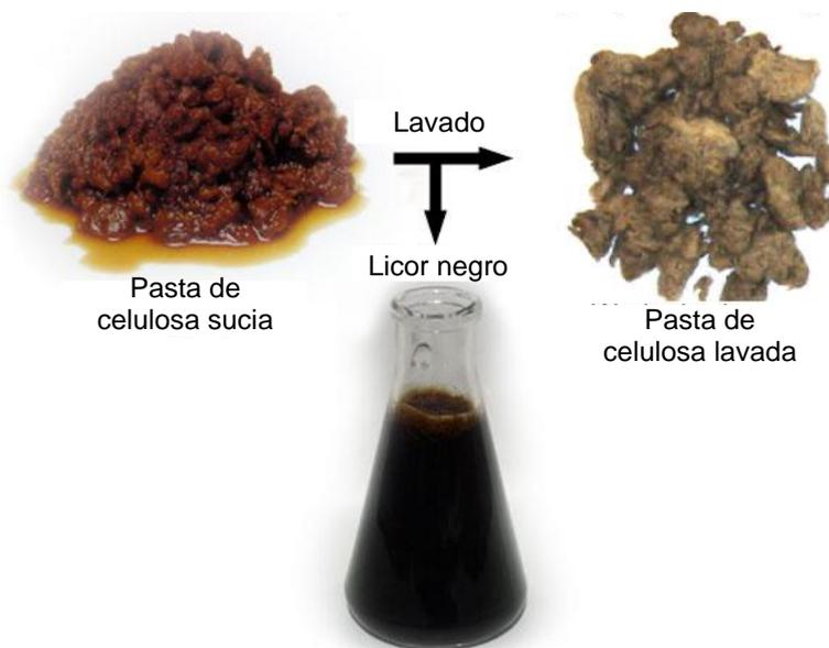
Figura 38: El lavado de pasta de celulosa sucia produce licor negro y pasta de celulosa lavada (KnowPulp, 2019)
