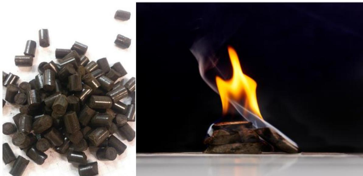
**Figura 46:** *Pellets de biocarbón e hydrochar* producidos con el proceso HTC de C-Green (Fuente: C-Green)
