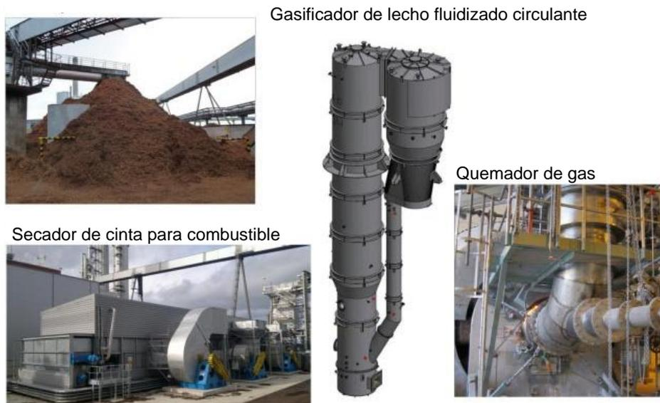
**Figura 51: Componentes de una planta de gasificación (Know pulp, 2019)**
