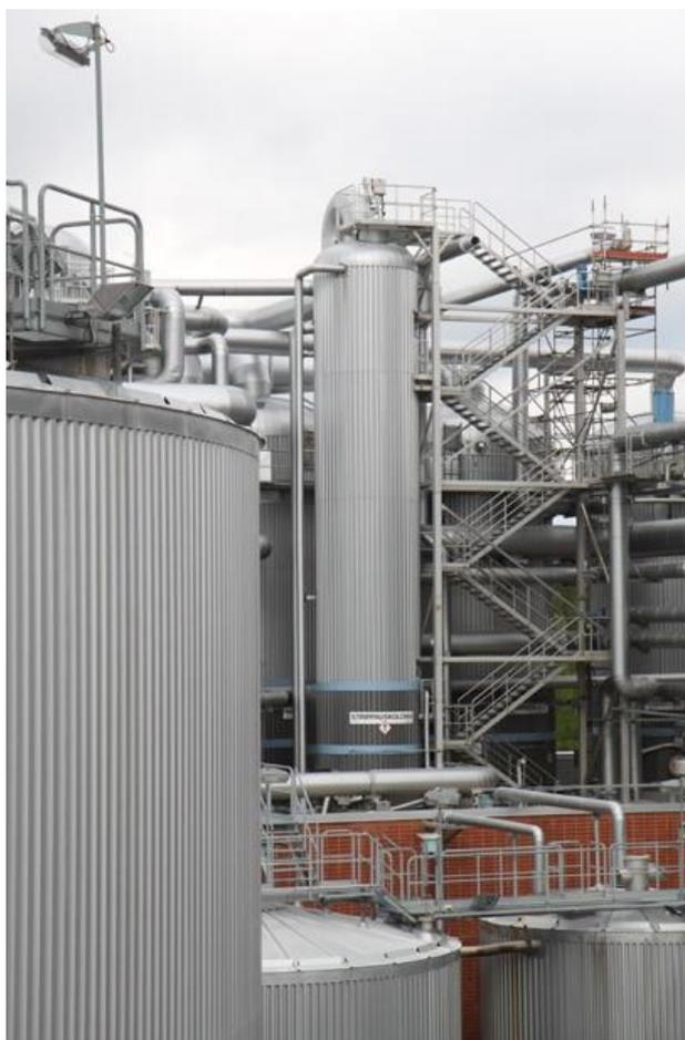
**Figura 45: Separación de metanol de la planta de celulosa: tanques de almacenamiento y sistema de extracción de condensado sucio (KnowPulp, 2019)**
