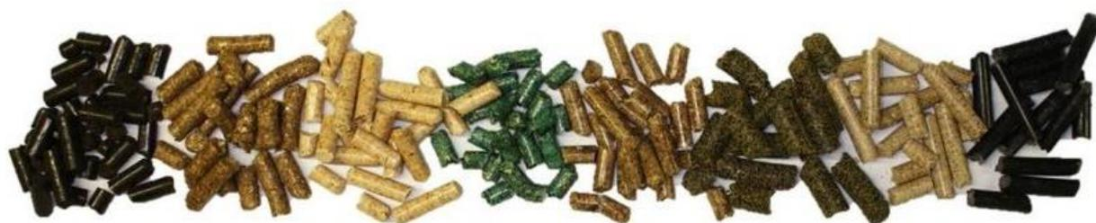
Figura 6: Ejemplos de *pellets* hechos de diferentes materiales y procesos (Fuente: DBFZ)
