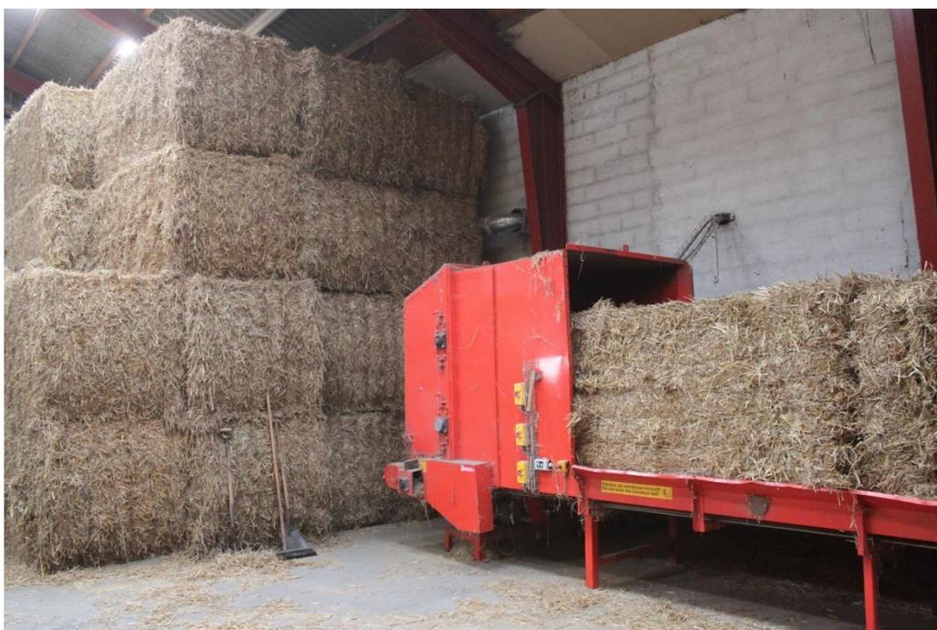
**Figura 11: Sistema de alimentación con balas de paja para una red de calefacción urbana en Dinamarca (Fuente: D.Rutz)**
